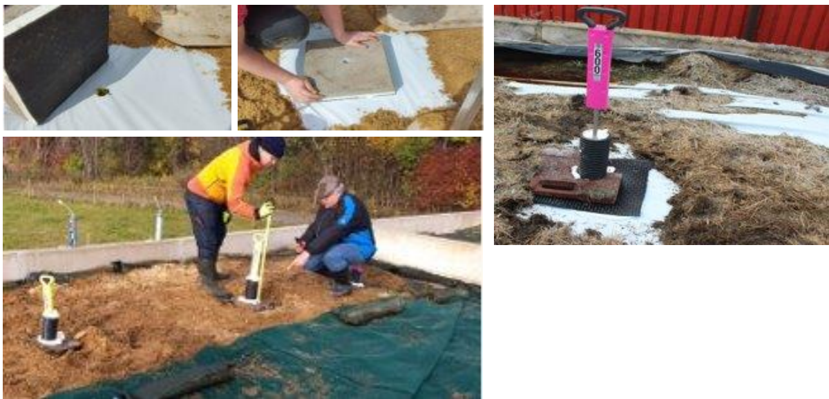
Kuva 1. Sensorisauvojen aumaan asennuksen eri vaiheita
